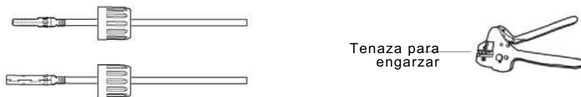
▲ Figura 4.10 Engarce la clavija de contacto al cable
